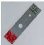
Step hole IQI for volumetric defects ASTM E1015 / EN ISO 19232 - 2
